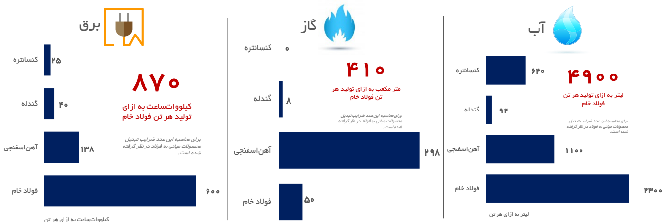
شکل ۱. برای تولید یک تن فولاد چقدر برق، آب و گاز مصرف می‌شود؟
